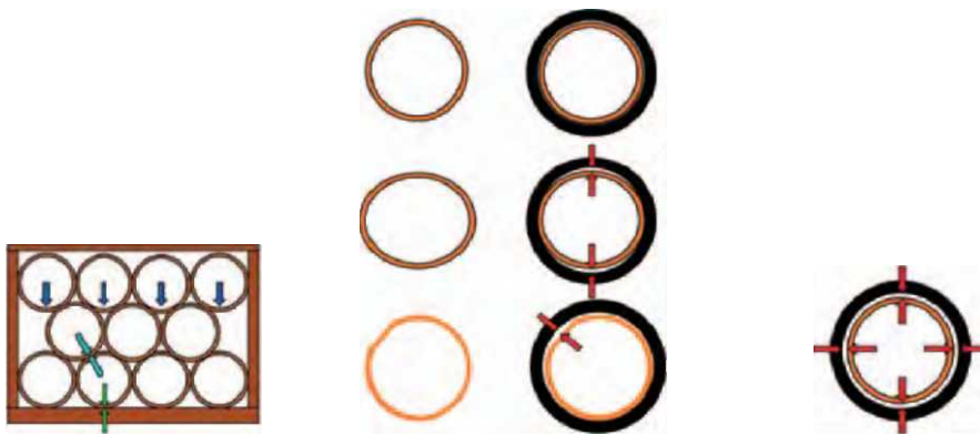
Рис. 6 Отклонения формы труб из полиэтилена. Отклонение от круглой формы или местное уплощение. Схемы возможных изменений контура трубы и их влияний.
