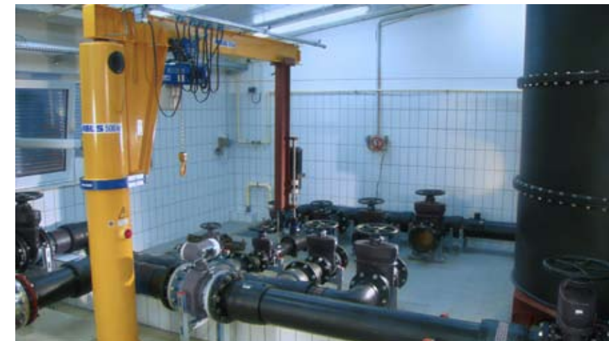
Рис. 6. Стенд для проведения динамических испытаний арматуры при рабочих давлениях до 16 бар и с расходами до 250 м³/ч.
