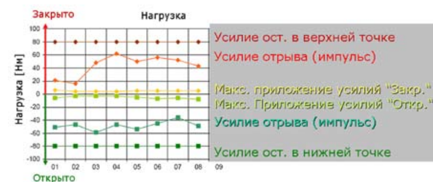
Рис. 4. Управляющие крутящие моменты, измеренные в ходе 8-месячной эксплуатации испытываемой арматуры: как и прежде, достаточным остаётся приложение лишь самых минимальных усилий.
