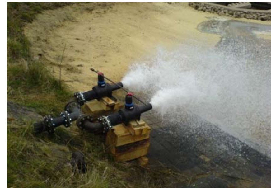
Рис. 9. Свободный сток воды через арматуру в положении дросселирования (т. е. не полностью открытую): крайне тяжёлое испытание для любой запорной арматуры.
