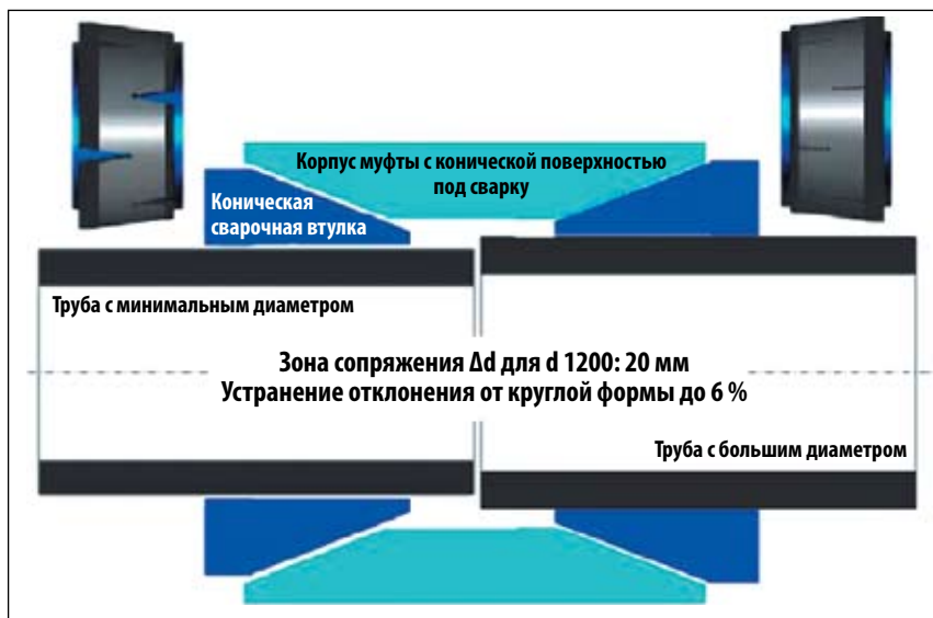
Рис. 7. Возможность сборки труб с разным фактическим диаметром.
