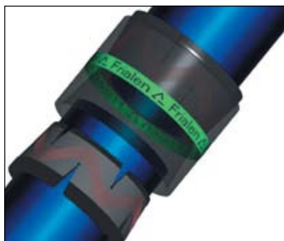
Рис. 5. Соединительная муфта, состоящая из двух конических сварочных втулок и корпуса. В нижней части трубы – конические втулки перед сборкой, в верхней – окончательном положении.
