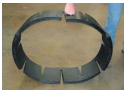
Рис. 8. Эластичность конической сварочной втулки упрощает ее установку на трубы с большим отклонением от круглой формы.
