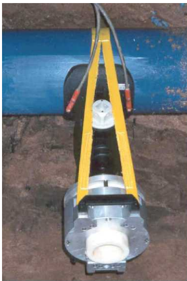
Рис. 6. Шаровой кран с механическим прижимным устройством (комбинация седлообразного отвода и задвижки для труб диаметром до 560 мм)
